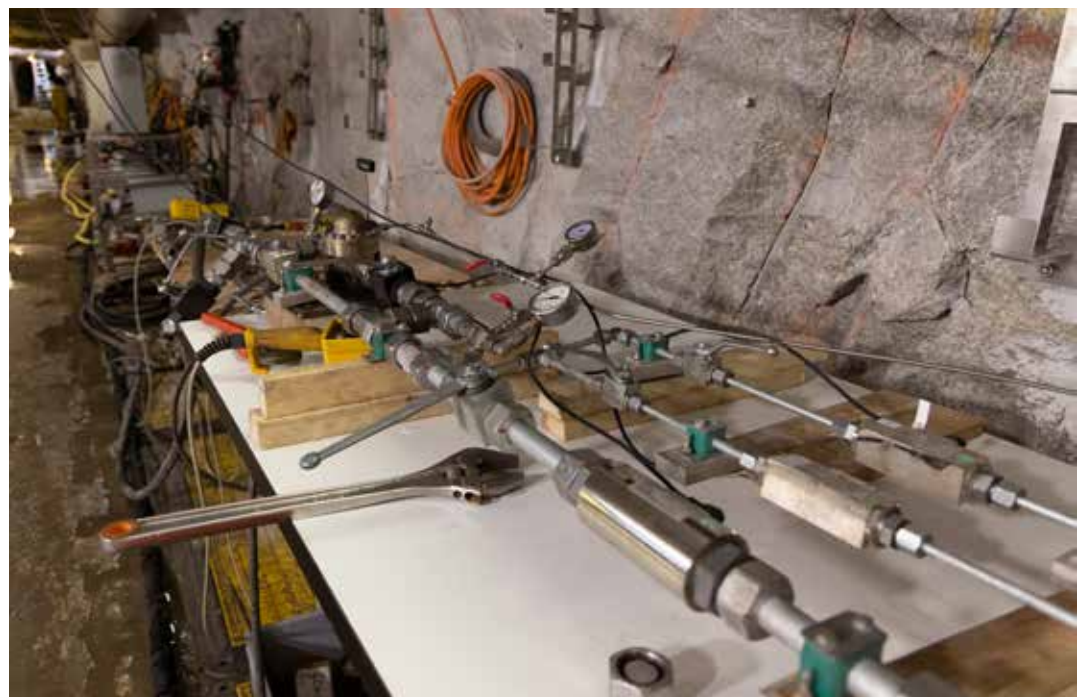
Un sistema di valvole e manometri aiuta a regolare la pressione dell'acqua. © BedrettoLab.
