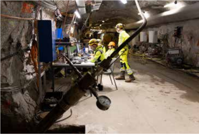
L'attrezzatura principale del laboratorio è situata proprio accanto al foro ST1, dove vengono condotte le stimolazioni. © BedrettoLab.
